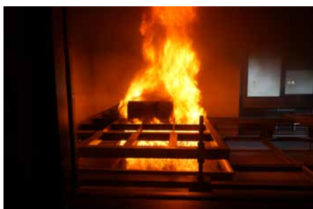
Flammehavet. Batteripakka ble grillet skikkelig uten å ta fyr.
