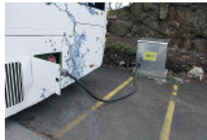
Ved hjelp av strøm fra dette 400 volt anlegget, blir bussen ladet.
