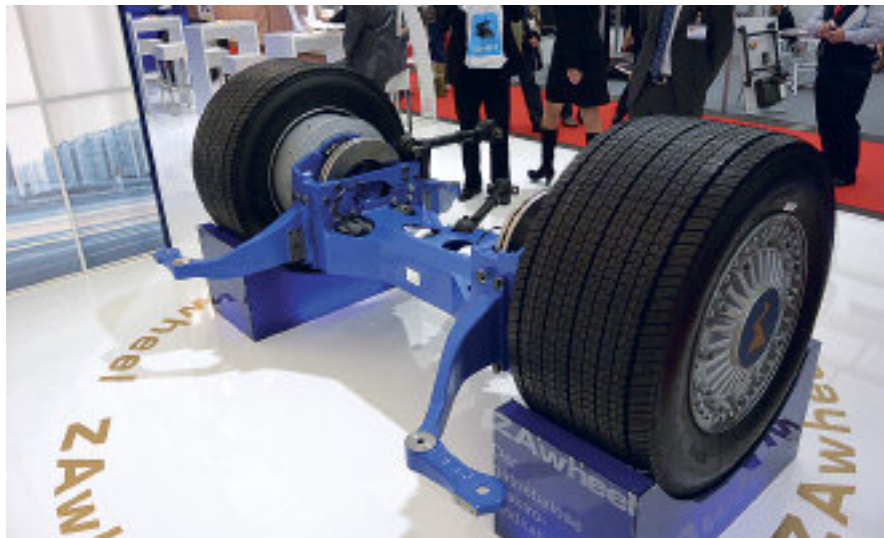
ZF sin portalaksel AVE 130 er et godt utviklet produkt med elektromotor fra Siemens. Akseltrykk 13 tonn og nå med fjæringsarmer i aluminium. Elektromotorene er på 2x120 KW, tilsvarende 329 hk. Det er en utrolig kompakt konstruksjon, vekt inklusiv motorer er bare 1100 kg. Konstruksjon er tilpasset for vanlige dekkdimensjoner med tvillinghjul. På en leddbuss kan det brukes to slike portalakslar med til sammen 4 motorer, det er en smart løsning for en leddbuss.
